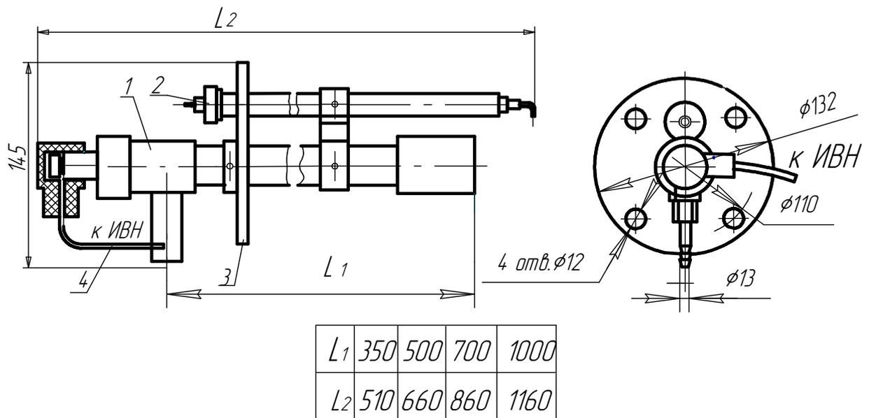
Рис.4 Монтажный чертеж ЭЗГ
