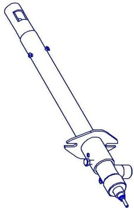
Общий вид горелки ЭЗГ-МК (вариант без ион-датчика).
