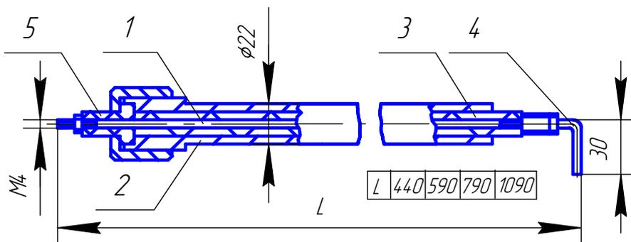
Рис.3. Ионизационный датчик.
