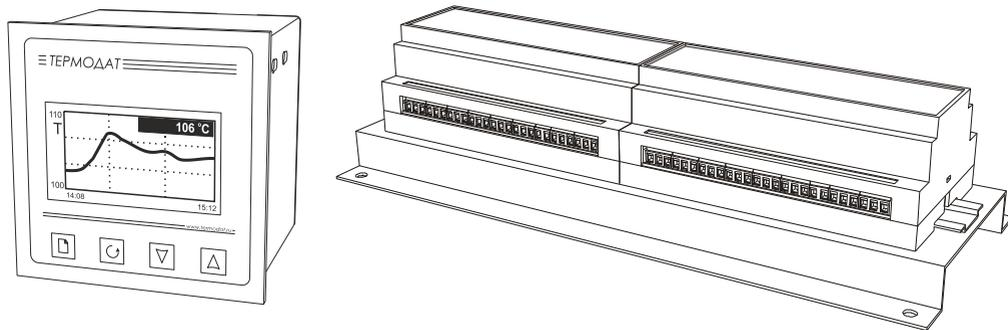
Прибор снабжен интерфейсом RS485 для связи с компьютером. Протокол связи Modbus ASCII и Modbus RTU. Для подключения прибора к компьютеру необходим преобразователь интерфейса USB/RS485 типа СК201. К одному устройству СК201 может быть подключено до 128 приборов.
