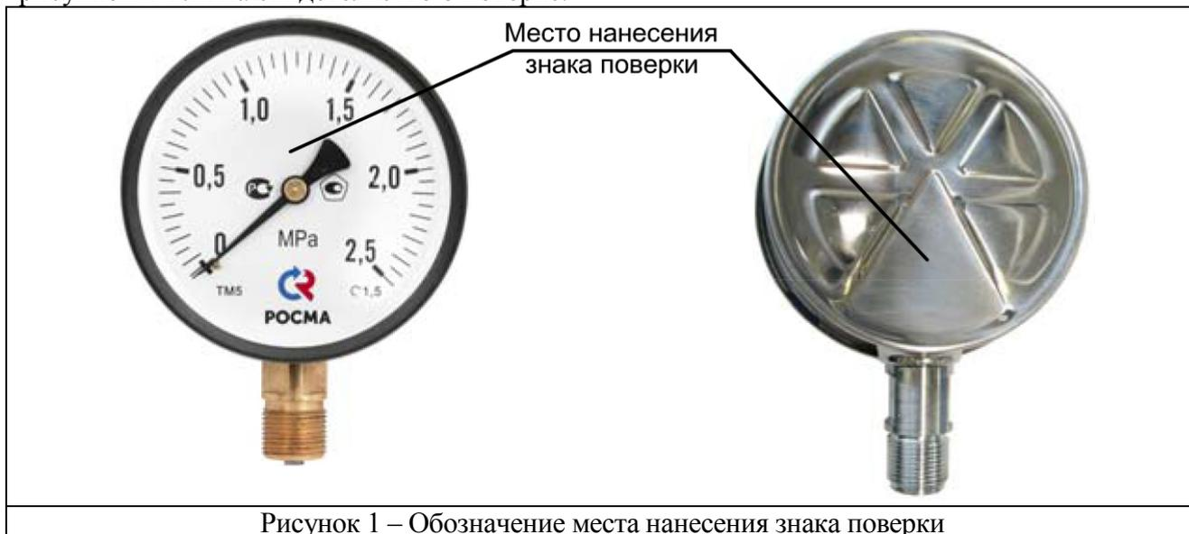
6.3 При отрицательных результатах поверки манометр к эксплуатации не допускают, свидетельство о поверке аннулируется и выписывается извещение о непригодности к применению.
